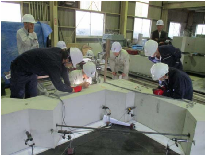
■ 載荷試験状況(閉方向)
